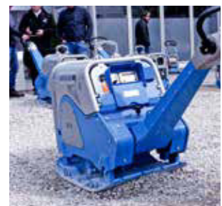
Disponibles con sistema de control de compactación / gestor de datos del motor.
